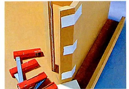
Дав клею ПВА высохнуть не менее 2 часов, стамеской аккуратно удаляют его излишки. Затем эксцентриковой шлифовальной машинкой обрабатывают все видимые стыки и кромки.
