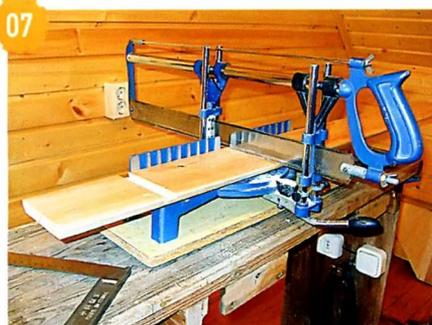
Сначала скопил продольные кромки декоративной доски под углом 45 градусов. Затем разметил на ней положение пазов под полки. Сделав по разметке запилы на половину толщины доски...
