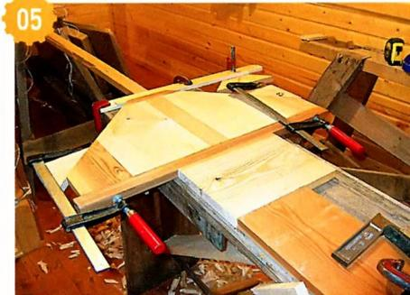
Чтобы хорошо притянуть к щиту приклеиваемую на шкантах длинную переднюю накладку, к скошенным боковым кромкам прибил гвоздями треугольные обрезки под губки струбцин (чтобы они не сползли).
