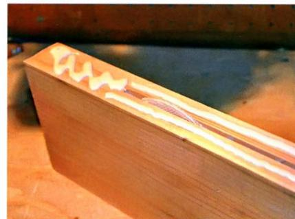
Для нарезки пазов под шпонки нам понадобилась ручная фрезерная машинка. Перед сплачиванием на кромки досок нанесли клей.
