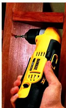
Лёгкие и компактные аппараты, предназначенные для работы в труднодоступных местах, обычно приобретают профессионалы. Инструмент оснащён угловым редуктором. Угловые дрели не бывают ударными, и мощность их невысока. Впрочем для работы в сложных условиях есть возможность использовать угловую насадку с обычной дрелью.
