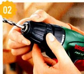
Существует два типа патронов: ключевые **01** и быстрозажимные **02**. В ключевом варианте сверло закрепляют специальным ключом — такое крепление более надёжно и не случайно именно оно обычно используется на мощных ударных дрелях. Быстрозажимные патроны делятся на одно- и двухмуфтовые. В первых легко закрепить сверло даже одной рукой. Во вторых нужно затягивать патрон двумя руками, что менее удобно.
