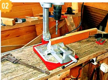
02 В кромках центральных щитовых деталей из лиственницы просверлил отверстия глубиной 25 мм под шканты. Затем, используя специальный кондуктор, просверлил ответные отверстия в кромках смежных деталей.
