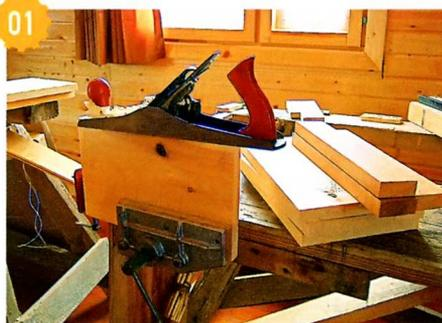
01 Подобрал заготовки для изготовления щитов из обрезков досок, сначала отфуговал их пласти и кромки.
