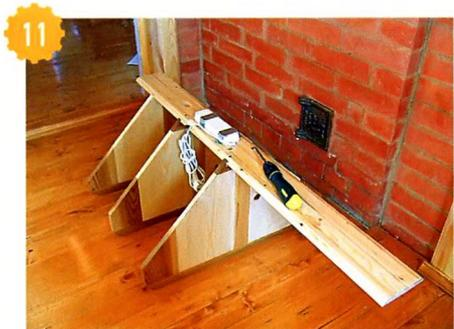
Блок розеток удлинителя закрепил в окошке декоративной доски с помощью жестяных полос, саморезов и двусторонней самоклеящейся ленты.
