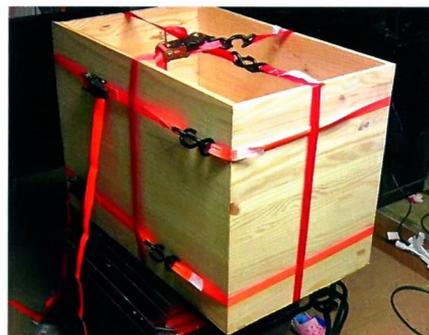
При склеивании корпуса использовали ремни для крепления груза.
