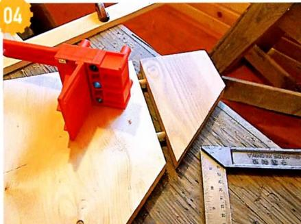
Боковые «крылышки» тоже приклеивал на шкантах. Поскольку подходящая доска из лиственницы была только одна, детали из неё делал нужной формы и лишь с небольшим припуском на финишную обработку.
